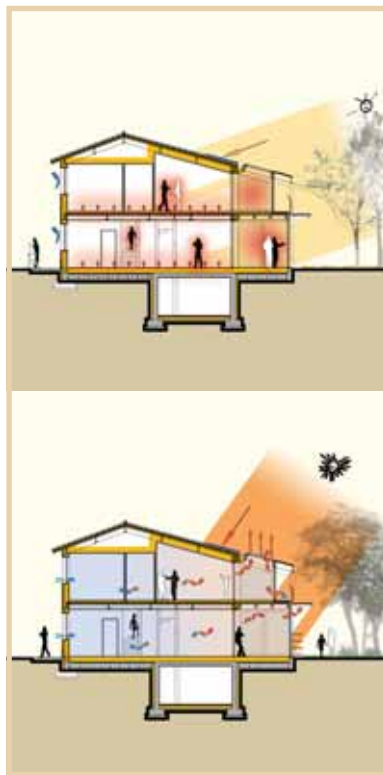
Schema del flusso energetico e luminoso nel periodo invernale ed estivo.
